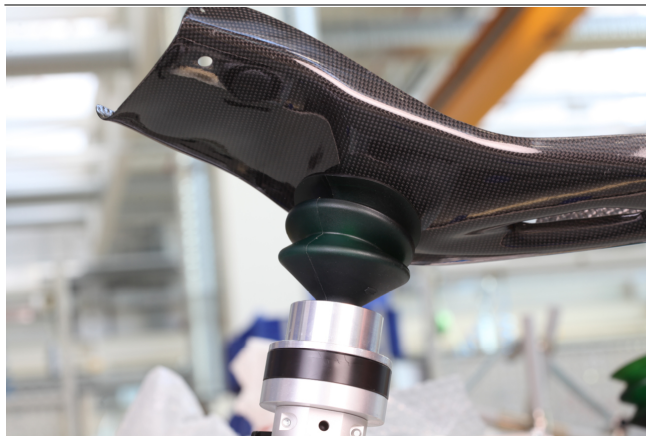
Uni-Base UB et ventouse de référence RSC lors du bridage d'un composant en PRFC
